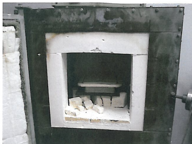
Fot. 9. Przebieg badań termicznych drzwiczek wyczystkowych.
