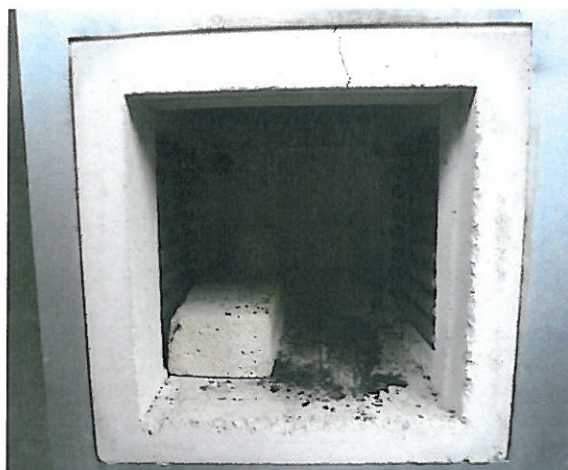
Fot. 8. Komora pieca do badań wysokotemperaturowych.
