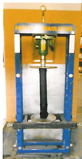
Fot. 4. Próba wytrzymałości na ściskanie systemu SPNP o grubości 1,2 mm.
