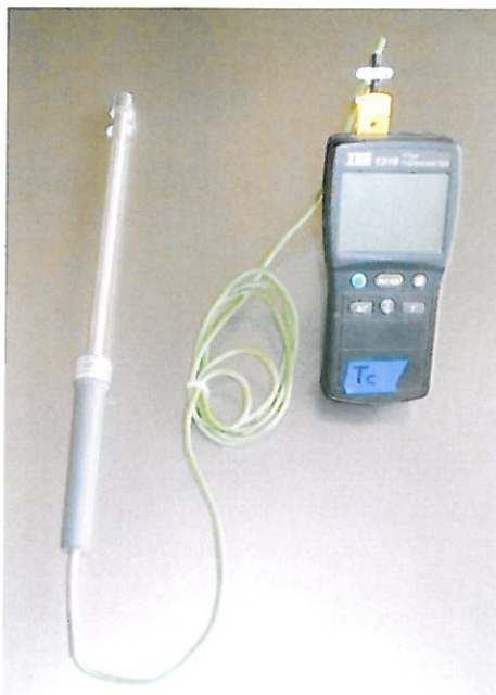
Fot. 6. Pomiar temperatury punktowej na płaszczyznach zewnętrznych elementu systemu przyłączeniowego oraz na płaszczyznach materiałów przy użyciu termometru typu TES 1319.
