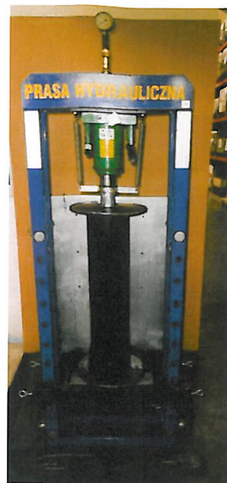
Fot. 2. Wytrzymałość na ściskanie rur wykonanych ze stali węglowej trudno rdzewiejącej DN 150.
