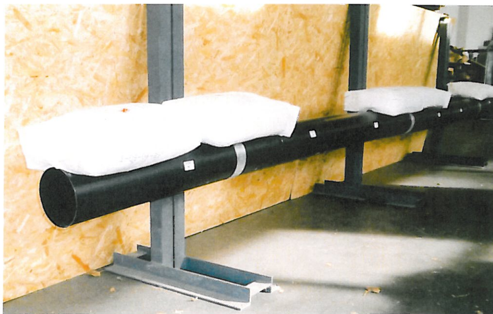
Fot. 4. Przebieg próby badania właściwości mechanicznych na obciążenie wiatrem.
