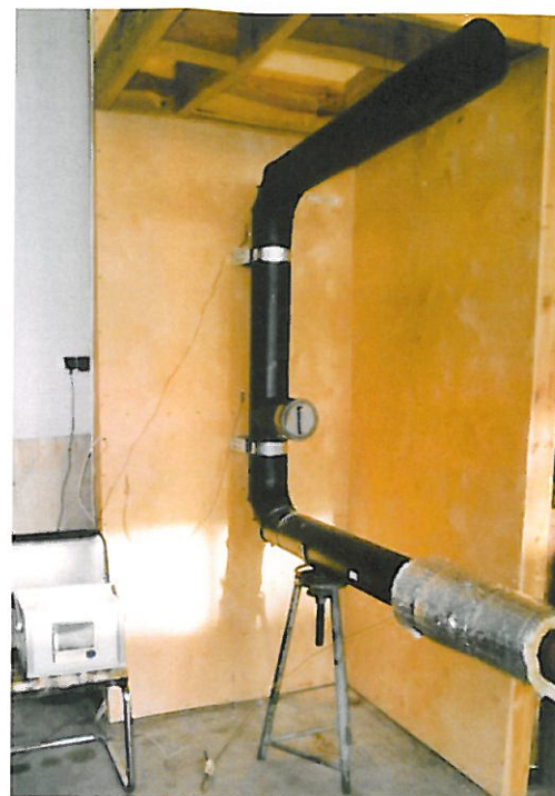
Fot. 5. Przebieg badania oporu cieplnego rur prostych.
